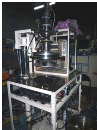
改造中のスパッタ装置
